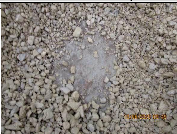
10. התגלתה רצפת בטון רטובה + תוך מספר דקות התחילו להגיע מים מהצדדים
