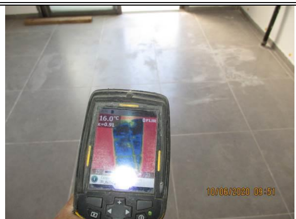
13. כאן ברצפת המטבח המצלמה התרמית מגלה הצטברות מים מרוכזת <
